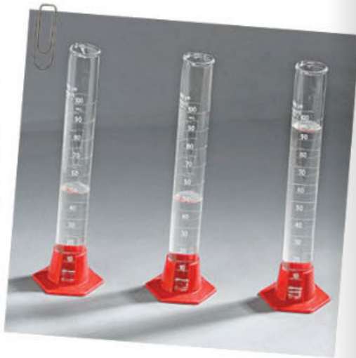
Figura 1.52 Al mezclarse algunos materiales su volumen no necesariamente es la suma aritmética de los volúmenes de cada uno.
