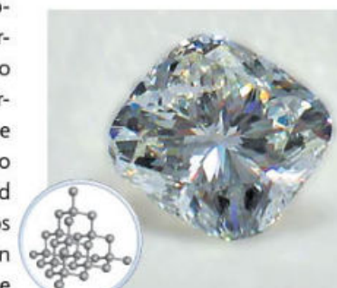
Figura 2.73 Arreglo cristalino del diamante.
