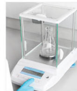
Figura 1.20 Las balanzas analíticas modernas son capaces de medir con una precisión de diezmilésimas de gramos.
