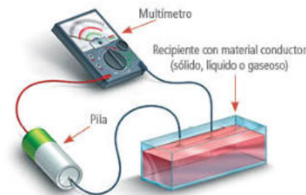
Figura 4.16 Con un multímetro puedes probar la conductividad eléctrica que tiene un material.
