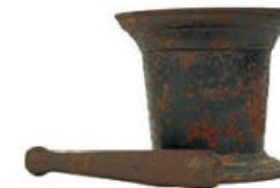
Figura 4.48 El hierro se ha utilizado desde la antigüedad para fabricar toda clase de utensilios y estructuras. Al oxidarse deja de ser útil, por lo que se estima que alrededor de 20% de la producción anual de hierro en todo el mundo se usa sólo para sustituir productos de hierro oxidados.
