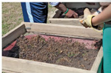
Figura 1.27 A la filtración de sólidos de diferentes tamaños por medio de mallas también se le llama cribado o tamizado.
