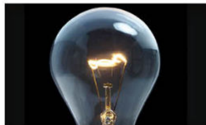
Figura 1.16 Algunas propiedades cualitativas, como la luminiscencia, el color o el olor, dependen de la temperatura. Una barra de metal brilla y emite luz al ser calentada hasta el punto del "rojo vivo", lo que también le ocurre al filamento de un foco al encenderlo.
