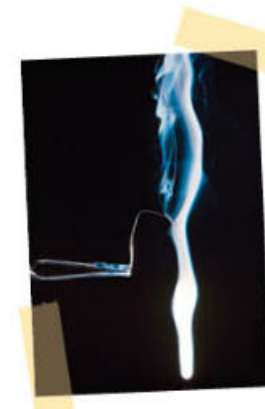
Figura 1.51 La combustión del magnesio deja como resultado óxido de magnesio, que tiene una masa mayor que el metal original.
