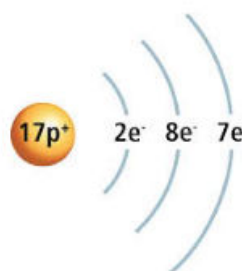
Figura 2.22 Diagrama de Bohr para el cloro. El cloro (Cl) tiene 17 protones y 17 electrones, de los cuales 7 están en su última capa. En general, el cloro tiende a recibir un electrón de otro elemento si está cerca.
